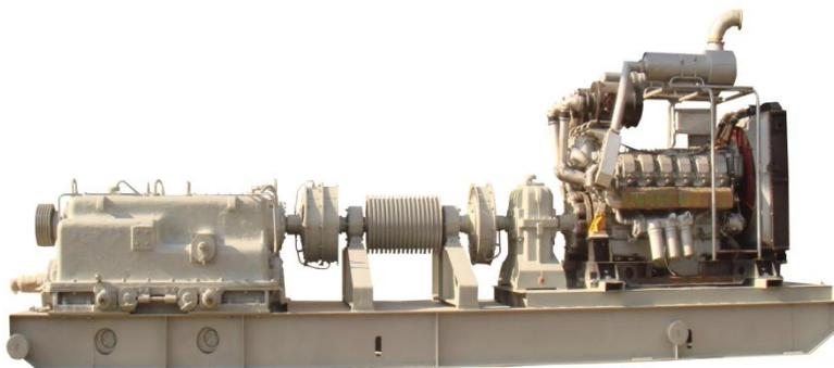
На агрегат силовой этого типа установлена силовая установка ЯСУ-500Б2, 1 трансмиссионный вал, коробка передач КПЗ-900Д чертёж № 14020.10.000.
