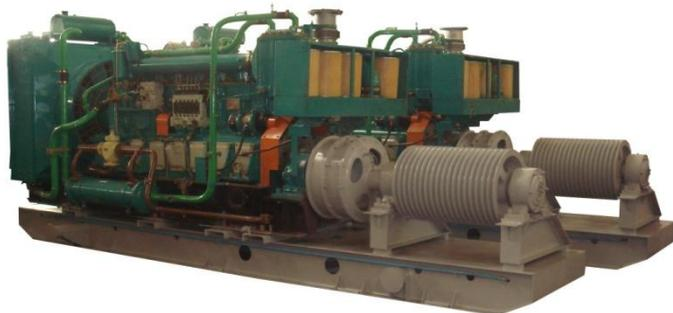
На агрегат силовой этого типа установлен силовой агрегат СА-25-01 мощностью 649квт, 1 трансмиссионный вал.
